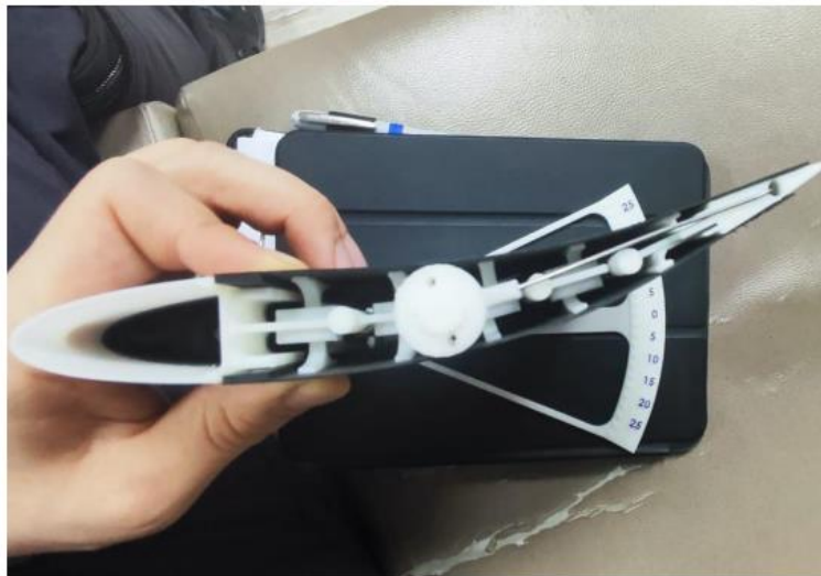
Şekil 6 20 derece deflection açısı verilmiş prototip
