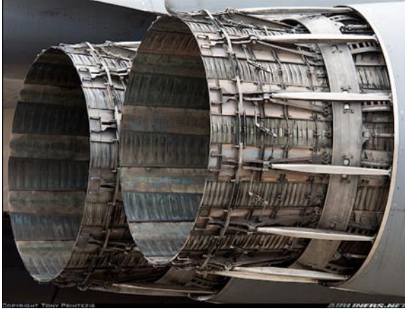
Şekil 2: Dairesel Kesitli İtke Yönlendirme Lülesi General Electric F101 [4]
