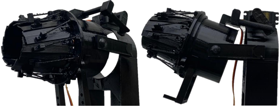
Şekil 5: a. FDM yöntemi ile üretilen prototip itki yönlendirme lüle mekanizmasının yönlendirilmemiş durumdaki gösterimi b. FDM yöntemi ile üretilen prototip itki yönlendirme lüle mekanizmasının yönlendirilmiş durumdaki gösterimi
