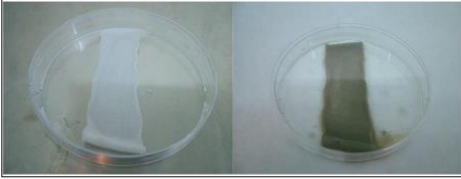
Şekil 5: Kumaş Şerit Testi (Kontrol Numunesi) Sonucu (test öncesi (sol), test sonrası (sağ))
