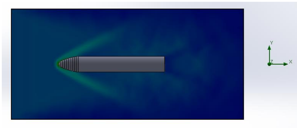
Şekil 41 Görselleştirilmiş Akış Simülasyonu, 6,7 Mach'ta Fırlatma Aracı (1. kademe ayrılmış)
