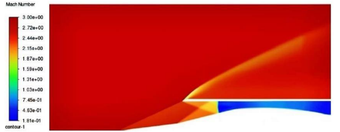
Şekil-4: Karışık Sıkıştırma Tipi Hava Girişinin Analiz Sonucu
