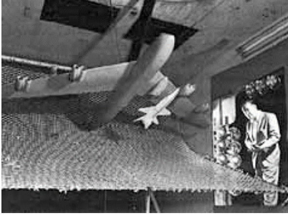
Şekil 2: X-15/B-52 Düşürme Testi
