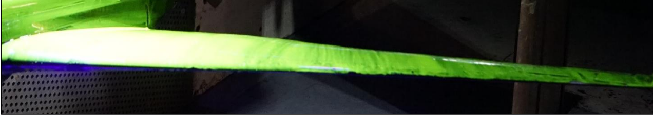
Şekil 3: Yağ uygulaması yapılan bir kanat
