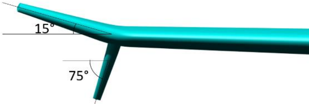
Şekil 3. \Gamma = 15^\circ/75^\circ kıvrım açılına sahip iki uç kanatçıklı ONERA M6 kanadı
