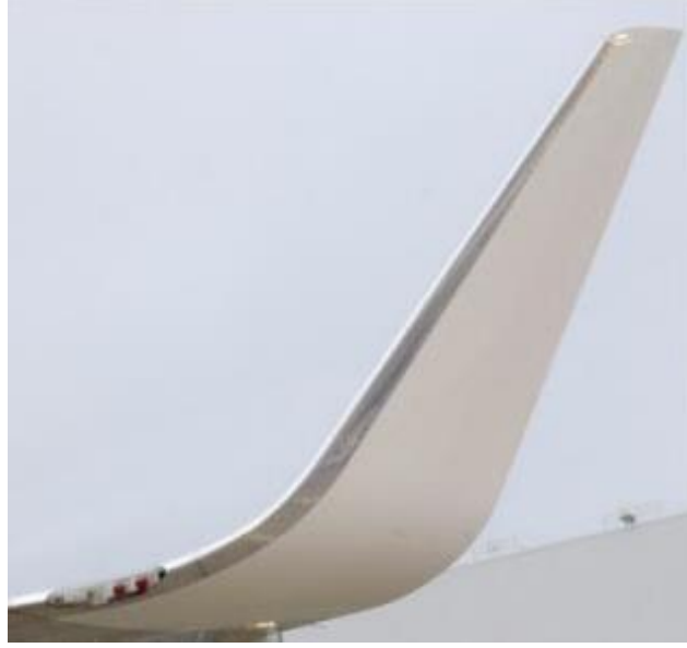
Şekil 1. API tarafından Boeing 737NG ailesi için geliştirilmiş yumuşak geçişli uç kanatçık [McLean, 2005].
