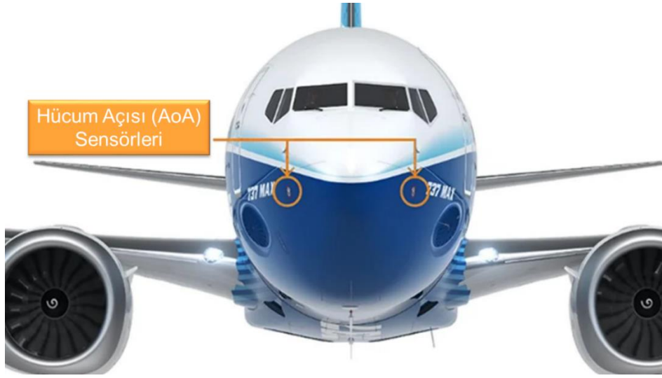
Şekil 8. Boeing 737-Max-8 AoA Sensörleri Yerleşimi [Wendel, 2019]
