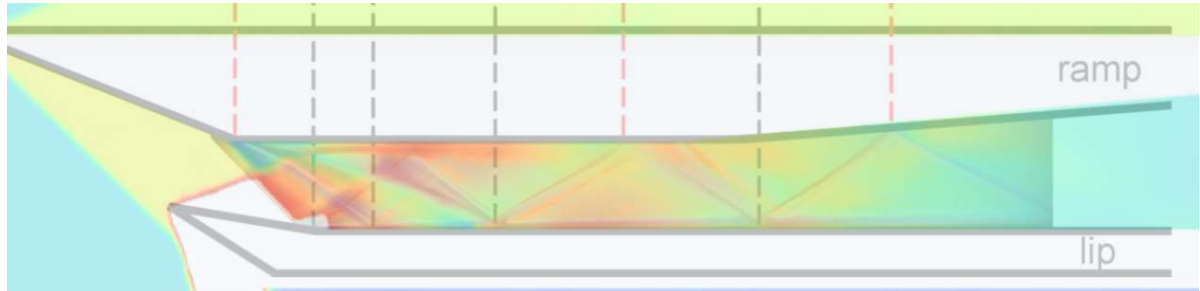
Şekil 9: Deneysel ve HAD analizi şok yapılarının görsel olarak üst üste konumlandırılması
