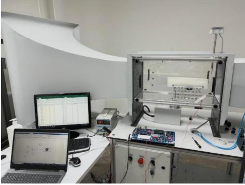
Şekil 10: Dört-kol mekanizması içeren şekil değiştirebilir kanat tasarımına ait rüzgâr tüneli testi
