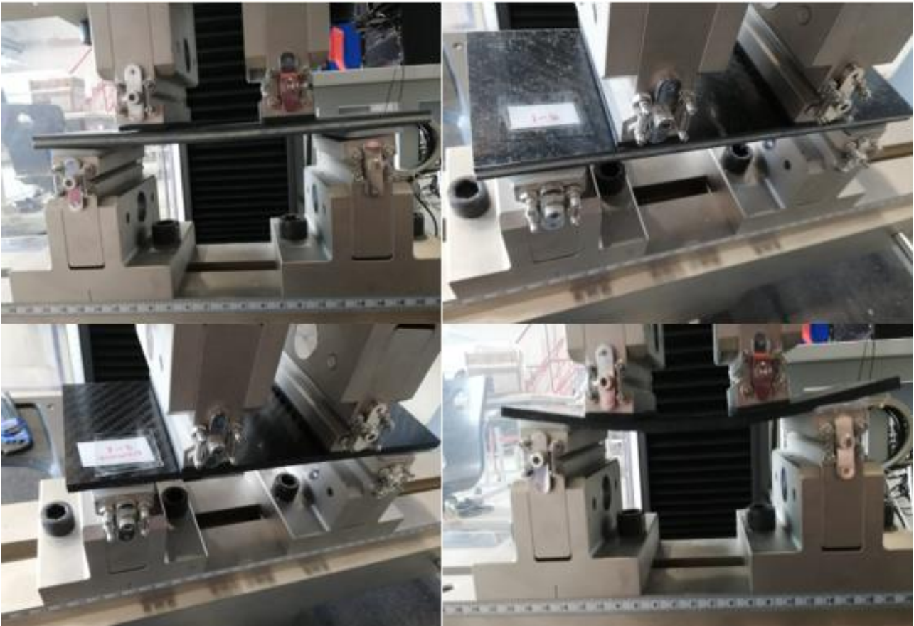
Şekil 7: Kompozit Lamina 4 Nokta Eğme Deneyi
