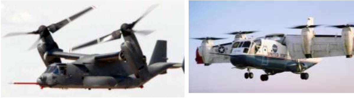
Şekil 1: Tilt Rotor (Bell Boeing V-22 Osprey) ve Tilt Wing (LTV XC-142) Hava Araçları
