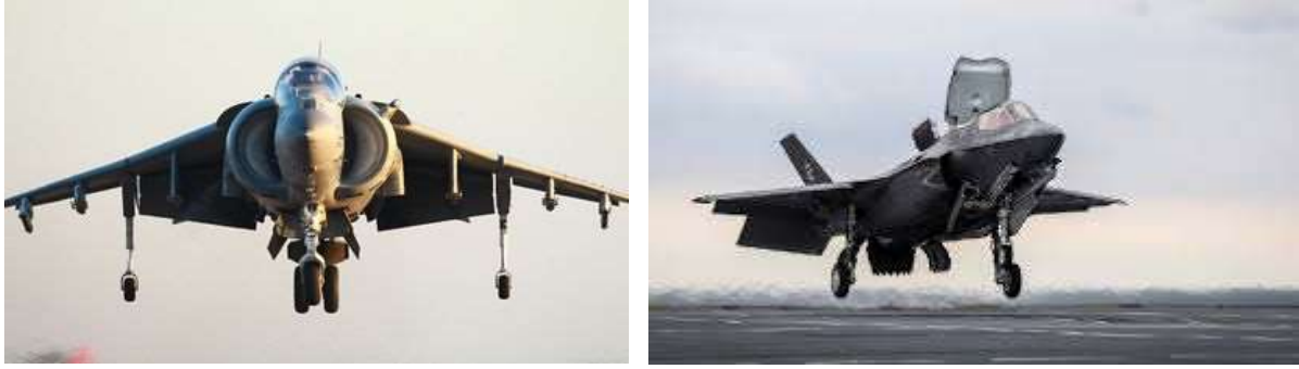
Şekil 3: İtki Yönlendirmeli (Vectored Thrust) British Aerospace AV-8 Harrier ve Lockheed Martin F-35B Hava Araçları
