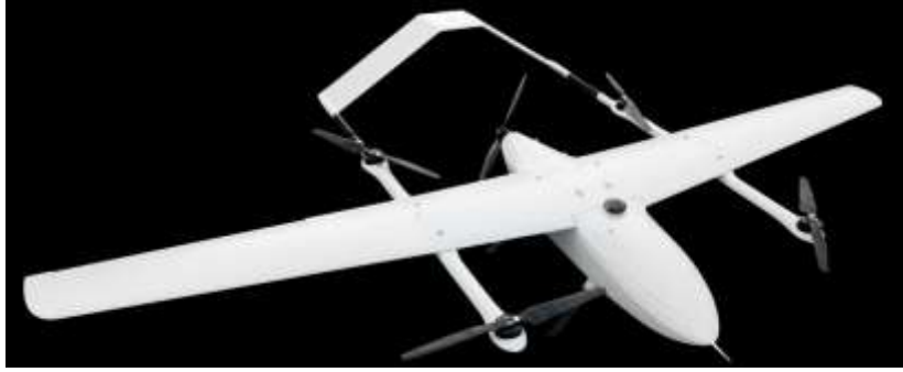
Şekil 7: Sabit Kanatlı Dikey İniş Kalkış Yapabilen bir insansız hava aracı
