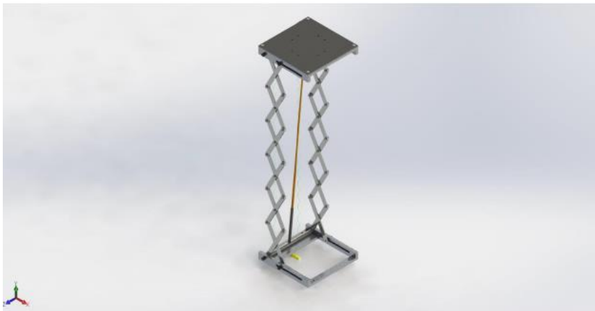
Şekil 3: Çalışma kapsamında tasarlanan yükseltme mekanizması.
