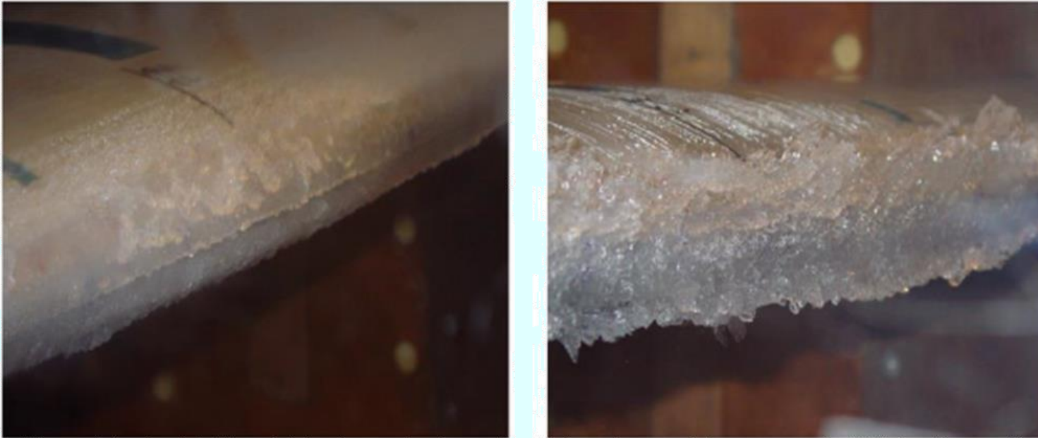
Şekil 4: Cranfield Buzlanma Tünelinden Kanat Üzerinde Oluşan Buz Şekilleri: Karsı Buz (Sol) ve Camsı Buz (Sağ) [Alegre, 2010]
