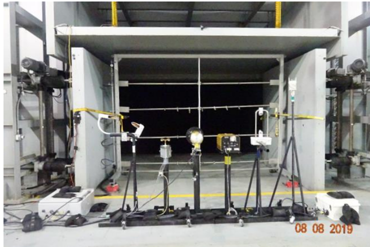
Şekil 3: Ontario Teknik Üniversitesi iklimlendirilmiş rüzgâr tüneli ve Prof. Dr. Gültepe tarafından geliştirilmiş optik uçuş alet sistemleri.
