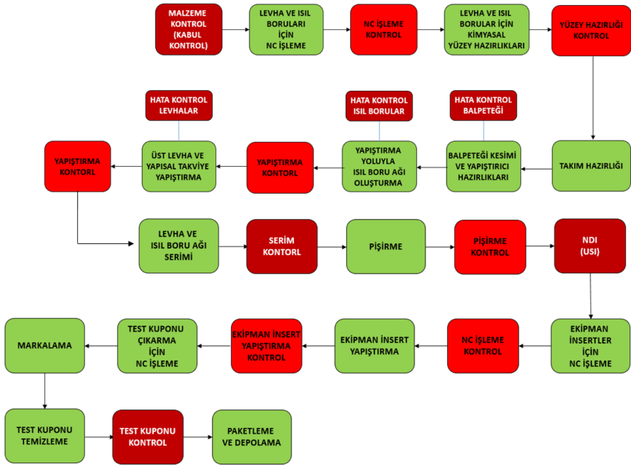
Şekil 8: Gömülü Isı Borulu Sandviç Panel Üretim Adımları
