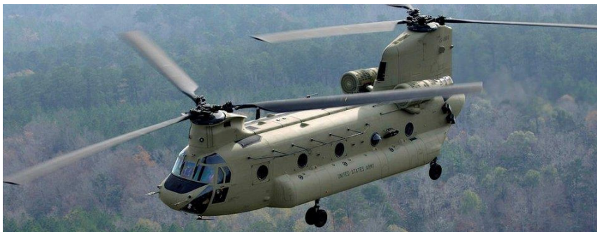
Şekil 19: Tandem Rotor Konfigürasyonu Kullanan Boeing CH-47 Chinook.
