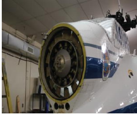
Şekil 27: NOTAR Sisteminin Kuyruk Kirişi (tailboom) Kaldırılmış MD520N Modelinin Fan Görünümü
