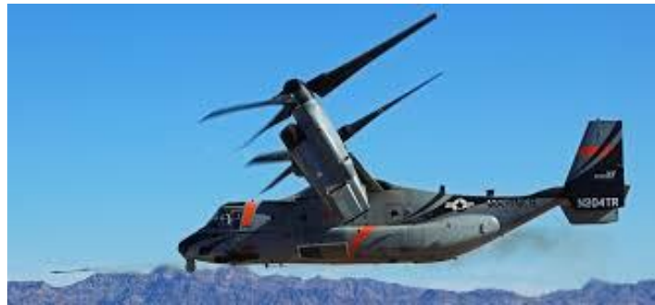
Şekil 21: Eğilebilen Rotor Sistemi Kullanan Bell - Boeing V-22 Osprey
