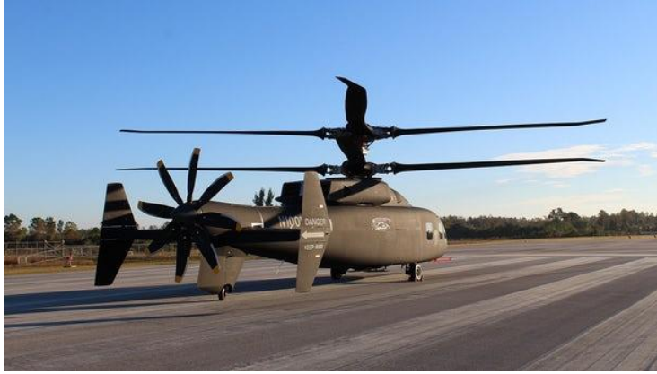
Şekil 18: Eş Eksenli Rotor ve İtici Pervane Kullanan Sikorsky-Boeing SB-1 Defiant
