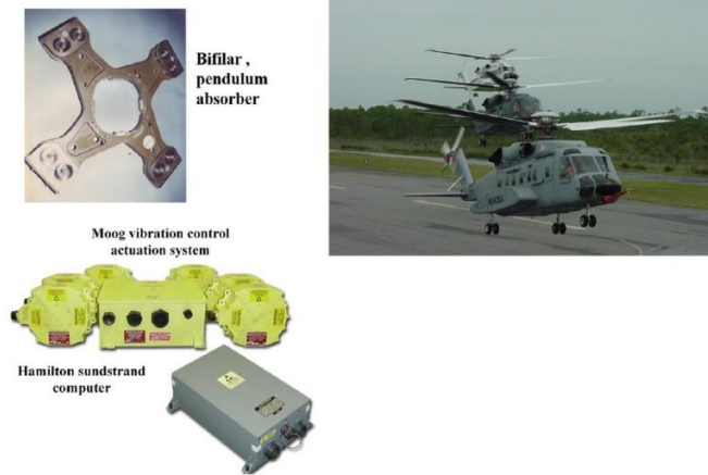
Şekil 37: Sikorsky S-92 Helikopterinde Bifilar, Sarkaçlı Sönümleyiciler ve Şasi Tabanlı Aktif Titreşim Sistemi (AVC) [Welsh,2018].
