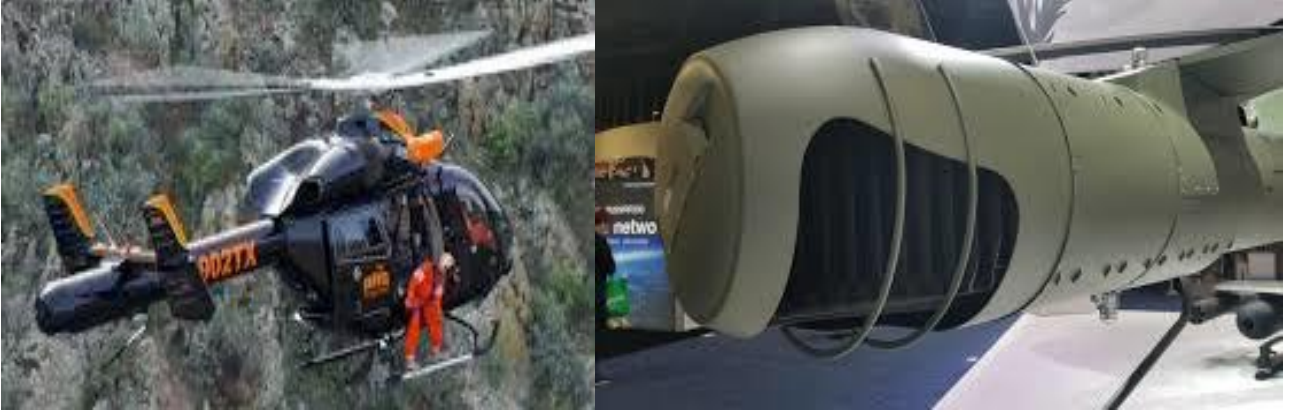
Şekil 28: NOTAR Sistemi Kullanan MD 902 ve MD 969 NOTAR Sisteminin Yakından Görünümü
