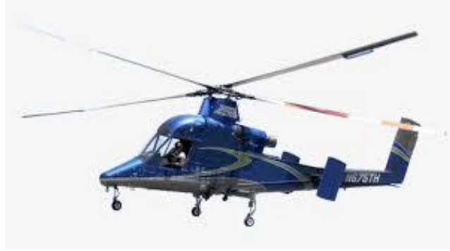
Şekil 20: İç İçe Döner Rotor Konfigürasyonu Kullanan Kaman K-Max
