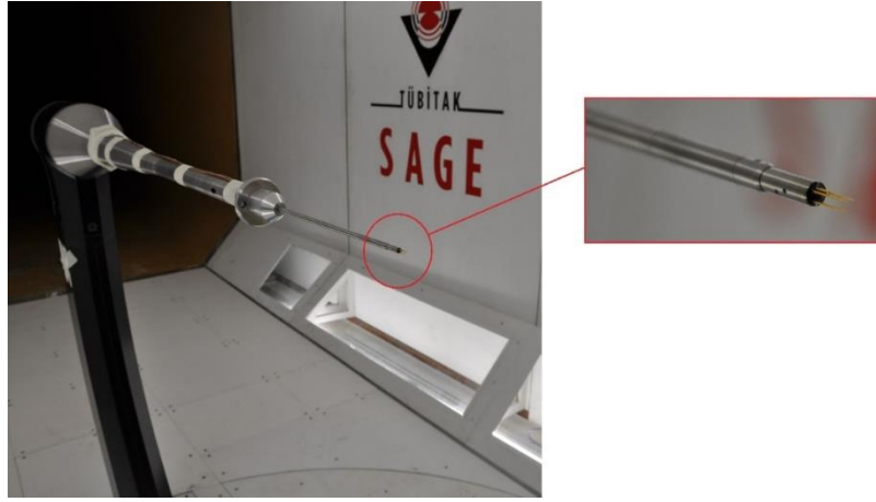
Şekil 11. Tutucu Kol Ucuna Bütünlenen Sabit Sıcak Tel Anemometre Ölçeri
