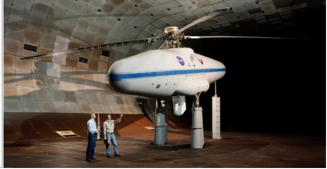
Şekil 5 S76 ana rotoru ileri uçuş aerodinamik performans analiz ve rüzgar tüneli test kıyası [Shinoda 1996]
