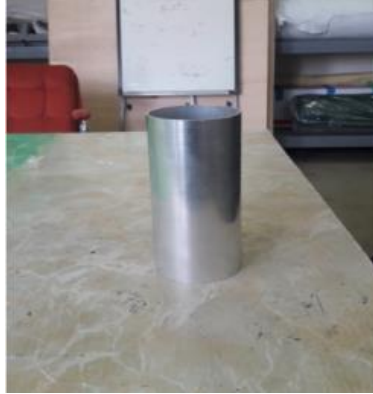
Şekil 1: İnce cidarlı metal silindirik kalıp
