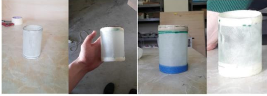
Şekil 7: Vakum infzyon ile üretilmiş cam fiber takviyeli polimer matrisli silindirik çarpışma kutuları
