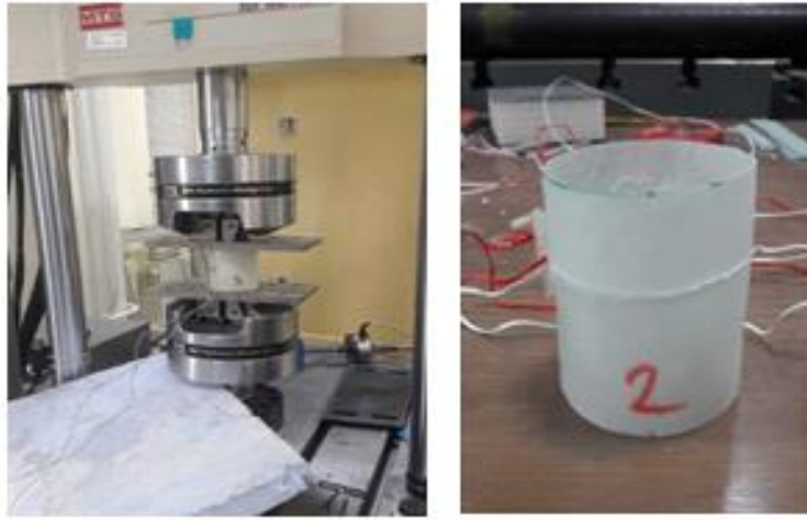
Şekil 10: Test makinası ve test sonrası tüpte meydana gelen hasarlar
