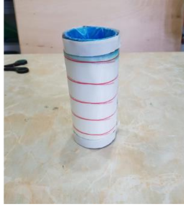
Şekil 4: Kalıbın cam fiber ve peel ply kumaşıyla sarılıp uçların macunlanması
