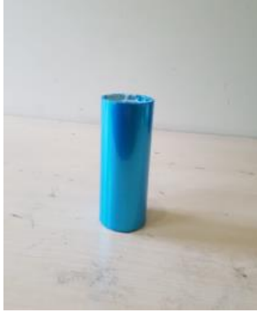
Şekil 2: Kalıbın vakum torbasıyla sarılması
