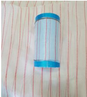
Şekil 3: Kalıbın peel ply ile sarılması
