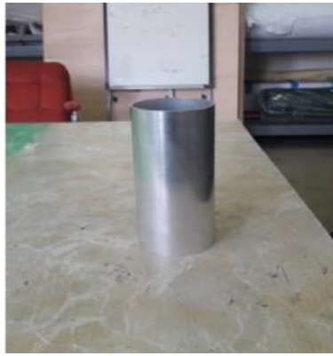
Şekil 1: İnce cidarlı metal silindirik kalıp
