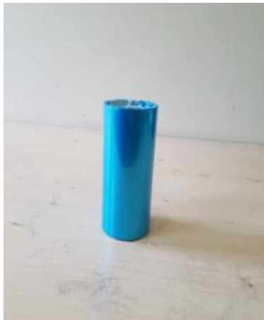
Şekil 2: Kalıbın vakum torbasıyla sarılması
