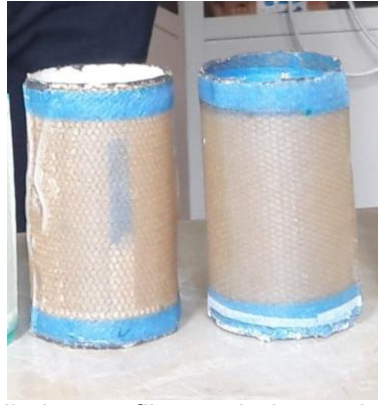
Şekil 6: Vakum infizyon ile üretilmiş cam fiber ve bal peteği tavviyeli polimer matrisli silindirik çarpışma kutuları
