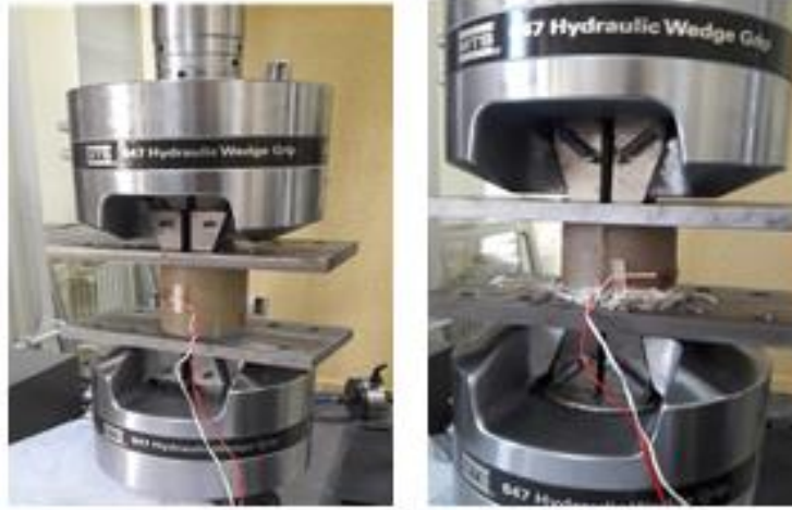
Şekil 9: Test makinası ve test sonrası tüpte meydana gelen hasarlar
