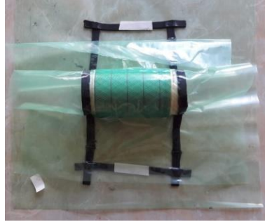
Şekil 5: Vakum infüzyon deneyi
