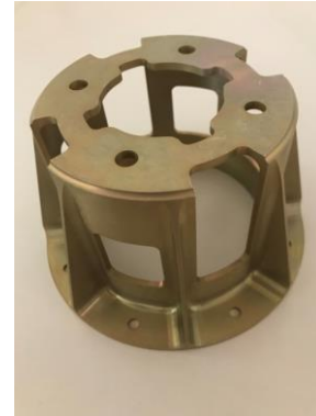
Şekil 4 Tasarım ve Üretimi yapılan TT Destek Braketi
