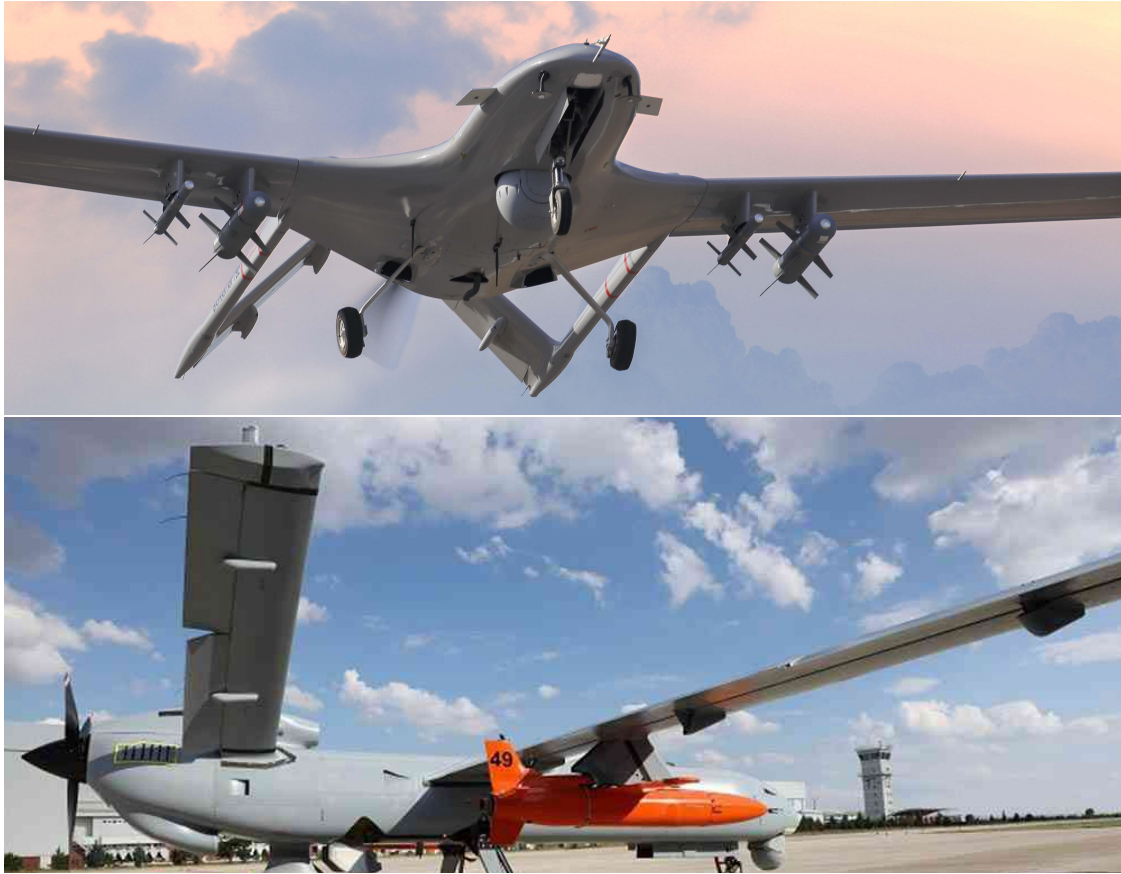
Şekil 1: Kanat altında yük taşıyan insansız hava aracı örnekleri. Yukarı görsel: Bayraktar SIHA [Baykar Savunma, 2020]; Aşağı görsel: TAI Anka [Haber Dergilik, 2020]
