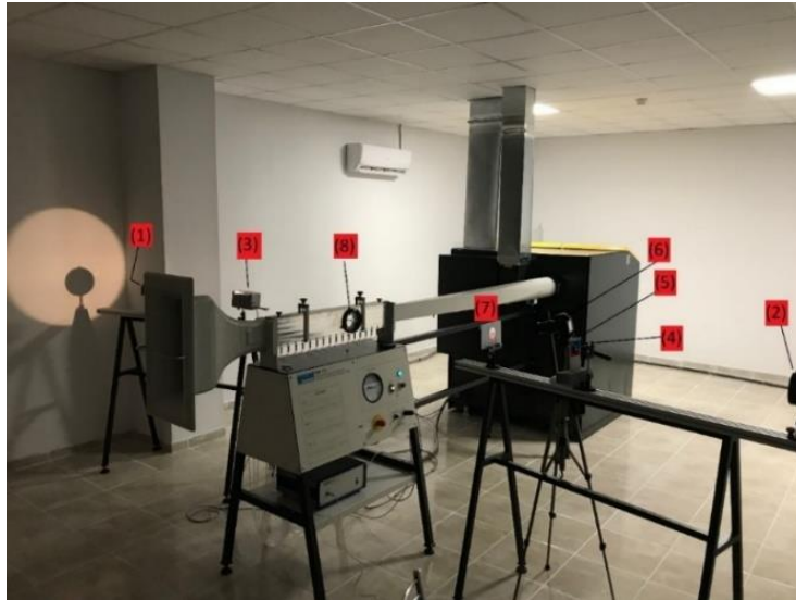
Şekil 3: HM-172 sesüstü rüzgar tüneli ve Schlieren sistemi
