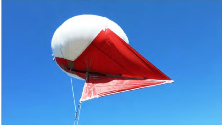
Şekil 3: Kablo GÜdümlü Hava Platformu (Helikite Model) [allsopp.co.uk, 2020]
